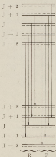
Fig. 4. Termschema ter verduidelijking van de zg. „staggering” der ultraviolette koolzuurbanden.
